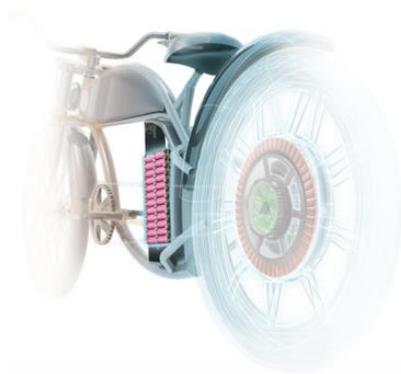
Rayvolt utilise 13 cellules en série pour atteindre une tension nominale de 48V. Au pic de tension, une charge complète de 54,6 V donne une puissance incroyable. Nous utilisons un minimum de 4 cellules en parallèle (52 cellules au total) et/ou 8 cellules en parallèle (104 cellules au total).
